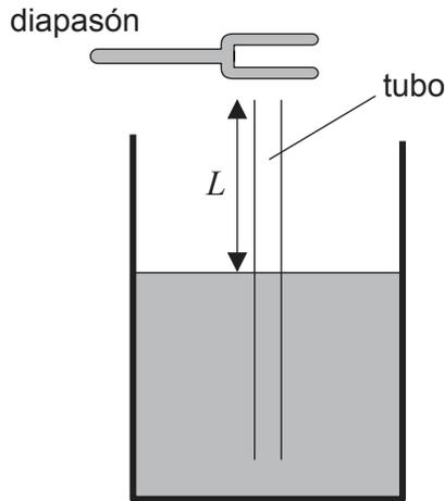
Se hace sonar un diapasón sobre el tubo. Para ciertos valores de  $L$ , se forma una onda estacionaria en el tubo.
