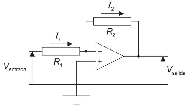
Demuestre que la ganancia del amplificador es  $\frac{V_{\text{salida}}}{V_{\text{entrada}}} = -\frac{R_2}{R_1}$ . [3]
